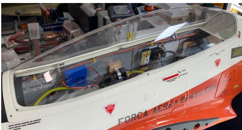
Acima: Parafusos para garantir segurança total na fixação do canopy e moldura do canopy.
