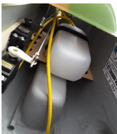
Acima: Posição típica do tanque e servos do acelerador e afogador. Abastecedores Johnny Simões (direita).
