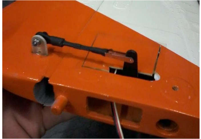
Acima: Posição do servo, braço de servo, horn e comando do profundor.
