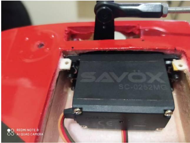
Acima: Posição do servo, braço de servo, horn e comando do profundor.
