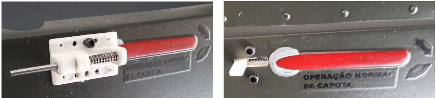
Acima: Posição da trava do conjunto canopy/moldura na fuselagem.
