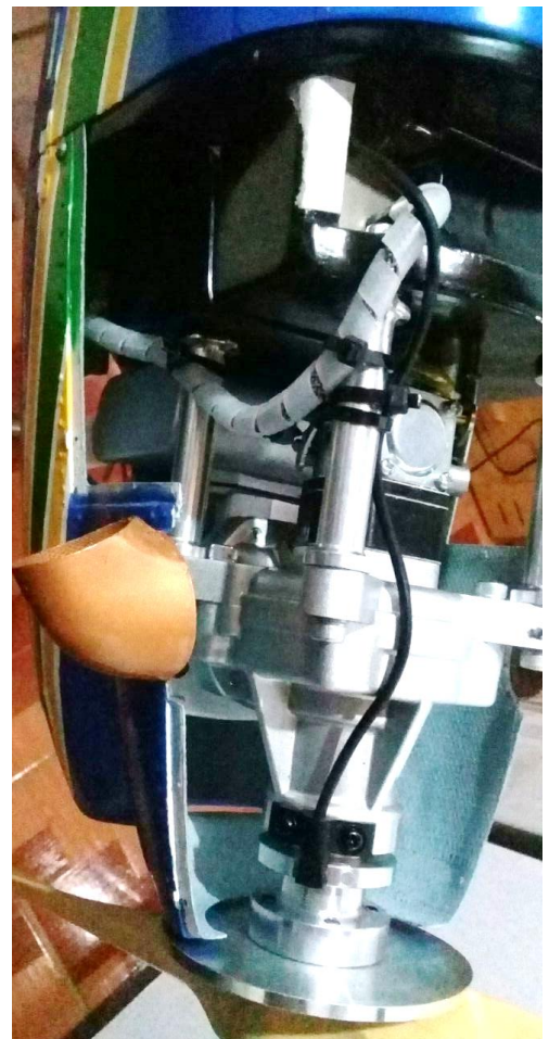
Acima: instalação do módulo de ignição atrás da parede de fogo lado superior (esquerda) e inferior (direita)
