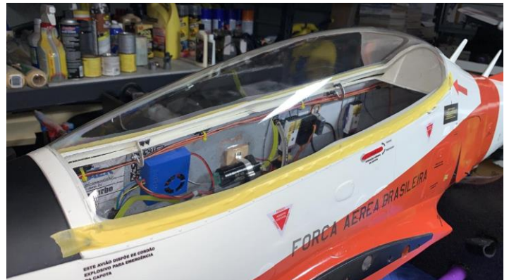
Acima: Canopy transparente recortado e pronto para colagem (esquerda) e colado e preso com fita adesiva.
