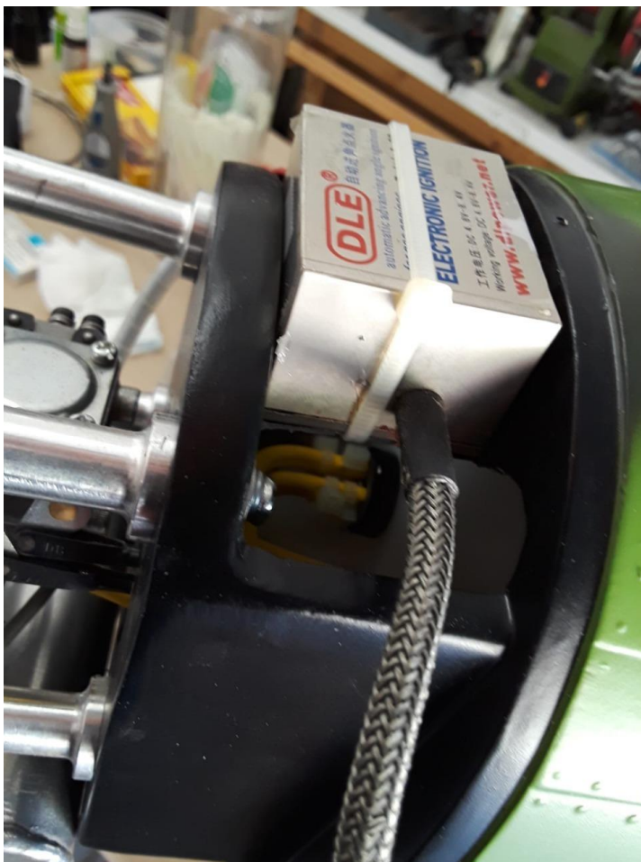
Acima: instalação do módulo de ignição atrás da parede de fogo lado superior (esquerda) e inferior (direita)
