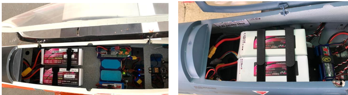
Acima: Exemplos de instalações de equipamentos no interior da fuselagem para a versão com motorização elétrica e posição das baterias de Li-Po.
