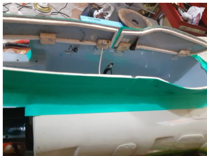
Acima: Instalação de mecanismo para abertura e fechamento das portas do trem de pouso dianteiro.
