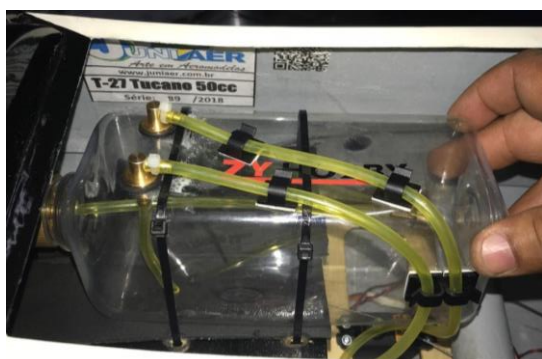
Acima: conexões do tanque e mangueiras tygon de gasolina.
