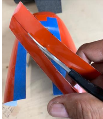
Acima: Processo de corte da carenagem inferior do motor e das 4 portas do trem de pouso dianteiro.
