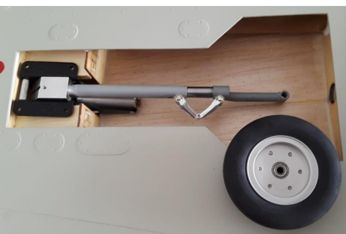
Acima: Posição dos retrâteis principais na asa
