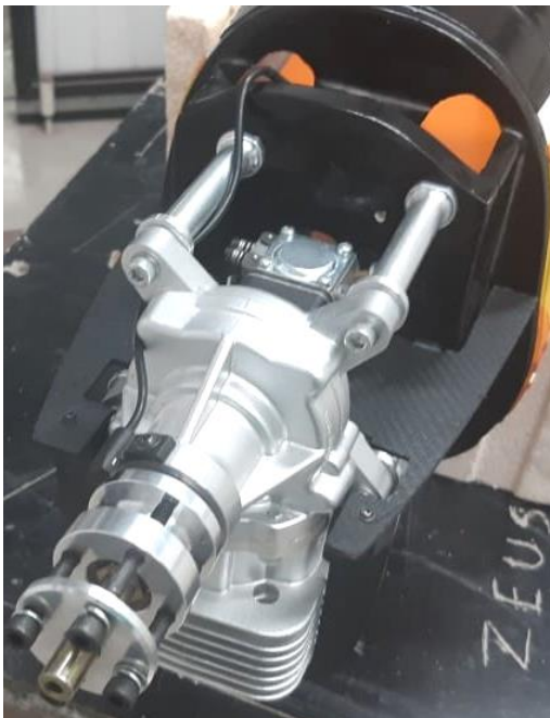
Acima: Separador de ar para arrefecimento.
