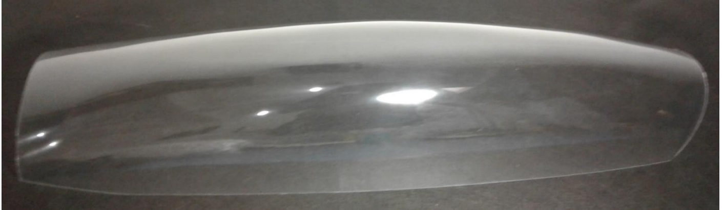
Acima: Formato correto desejado do canopy transparente após recorte.
