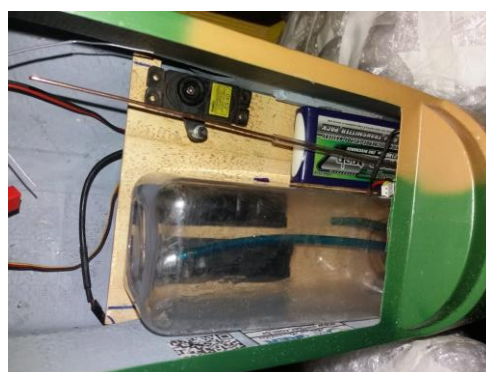
Acima: conexões do tanque e mangueiras tygon de gasolina.
