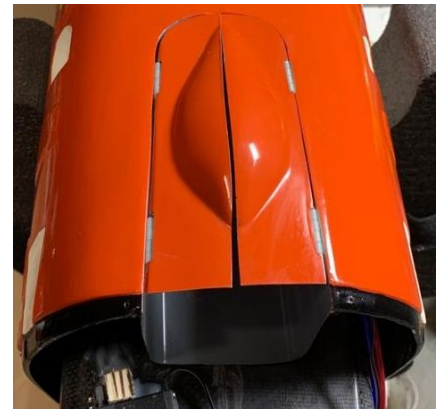
Acima: Fixadas com dobradiças Dubro, as duas portas dianteiras do trem de pouso dianteiro na carenagem inferior do motor (esquerda) e as duas portas traseiras do trem de pouso dianteiro na fuselagem (direita).
