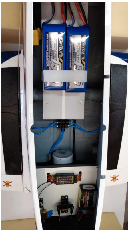
Acima: Posição das baterias de Li-Po utilizadas na versão com motorização elétrica. Definir posição definitiva após correto balanceamento do C.G.
