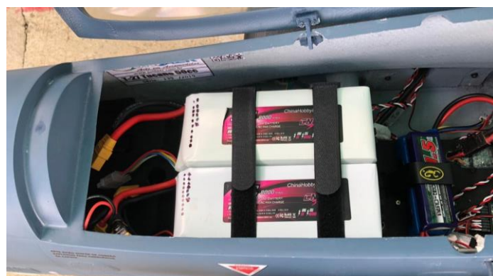
Acima: Exemplos de instalações de equipamentos no interior da fuselagem para a versão com motorização elétrica e posição das baterias de Li-Po.
