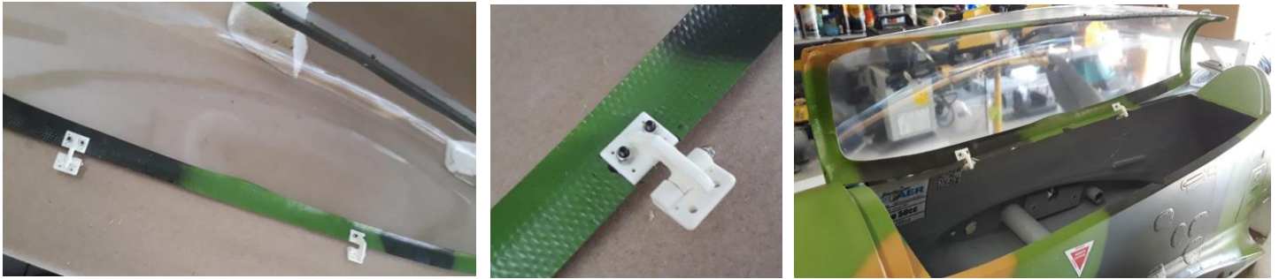
Acima: Fixação das dobradiças internas para abertura lateral do canopy.
