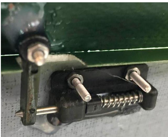
Acima: Travamento do conjunto canopy/moldura do canopy no interior da fuselagem.
