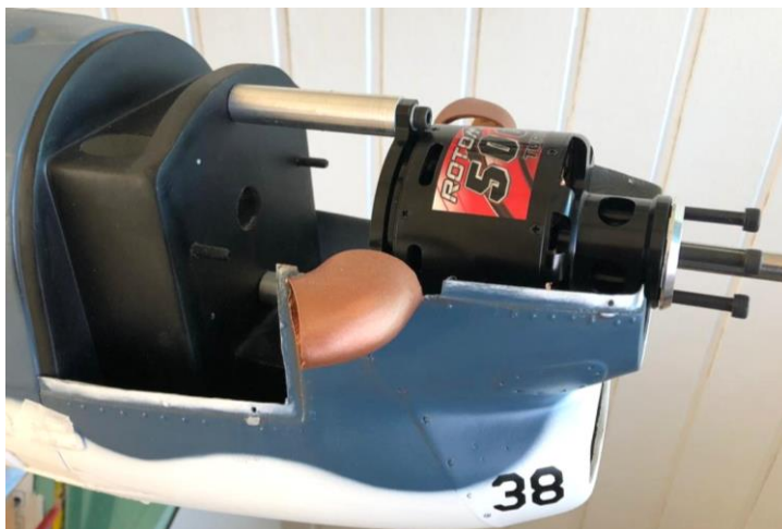
Acima: Instalação da parte inferior (esquerda) da carenagem do motor e ambas com alinhamento (direita).
