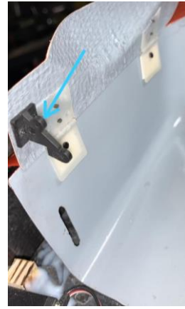
Acima: As 2 portas traseiras do trem de pouso dianteiro em posição final (esquerda), horn instalado na porta traseira do trem de pouso dianteiro (centro) e local de fixação do micro servo (direita).
