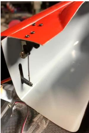
Acima: Servo esquerdo da porta traseira do trem de pouso dianteiro instalado com lincagem e horn (esquerda), posição do trem de pouso dianteiro, portas traseiras, servos e horns (centro) e 2 servos instalados na carenagem inferior do motor para abertura e fechamento das portas dianteiras do trem de pouso dianteiro.
