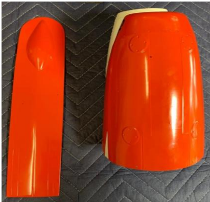
Acima: Processo de corte da carenagem inferior do motor e das 4 portas do trem de pouso dianteiro.
