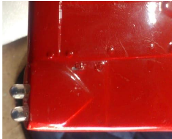
Acima: Placa de luzes do leme instalada na parte traseira inferior.
