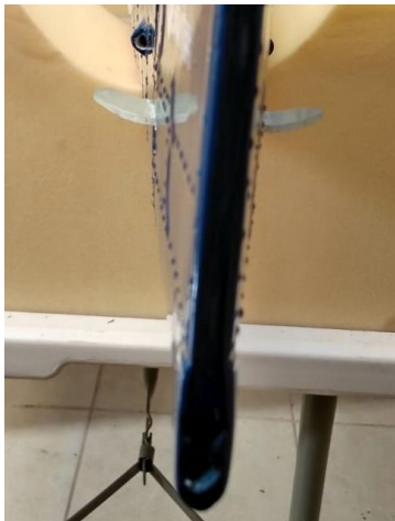
Acima: Horns duplos do leme (esquerda) e posição do servo de leme dentro da fuselagem (direita).
