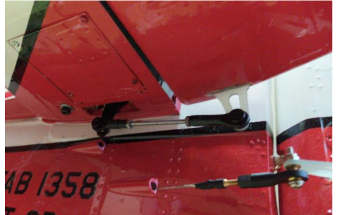
Acima: Posição dos servos, braços de servos e horns de comando dos profundores e saída dos cabos de aço “pull-pull” e horn duplo do leme.
