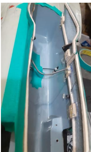
Acima: Instalação de mecanismo para abertura e fechamento das portas do trem de pouso dianteiro.
