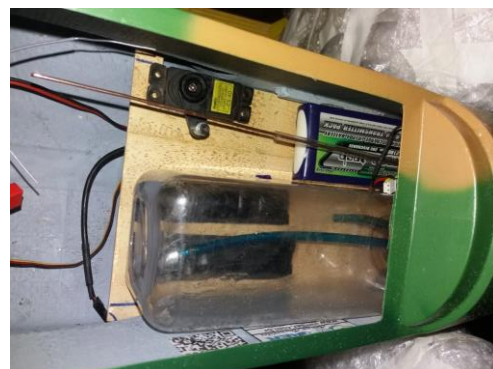
Acima: conexões do tanque e mangueiras tygon de gasolina.
