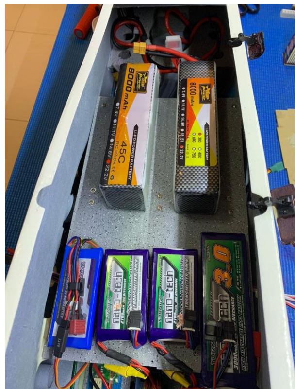
Acima: Posição das baterias de Li-Po utilizadas na versão com motorização elétrica. Definir posição definitiva após correto balanceamento do C.G.
