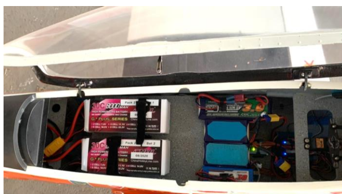
Acima: Exemplos de instalações de equipamentos no interior da fuselagem para a versão com motorização elétrica e posição das baterias de Li-Po.
