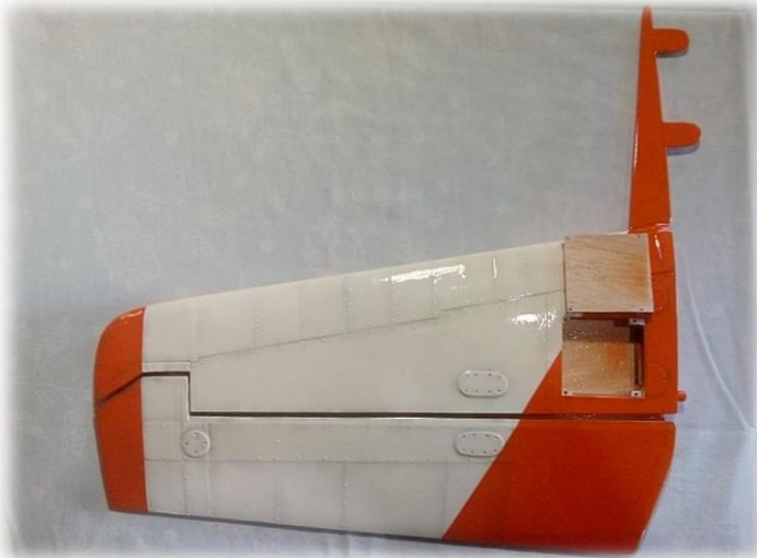
Acima: Localização da tampa de acesso ao servo do profundor(esquerda) e base de fixação do servo (direita).
