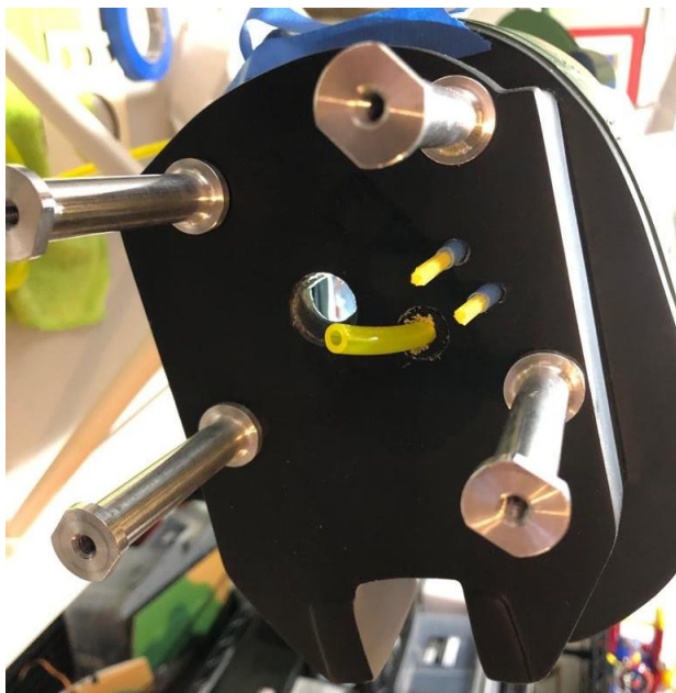
Acima: instalação dos montantes do motor (stand offs) e furos para pushrods do acelerador e afogador e mangueira tygon de gasolina (esquerda) e motor instalado nos montantes (direita).
