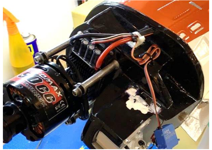
Acima: instalação de motor elétrico e speed control na posição horizontal (esquerda) e vertical (direita).
