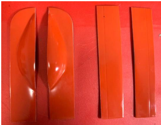
Acima: As 4 portas do trem de pouso dianteiro recortadas (esquerda) e suas posições (centro e direita).
