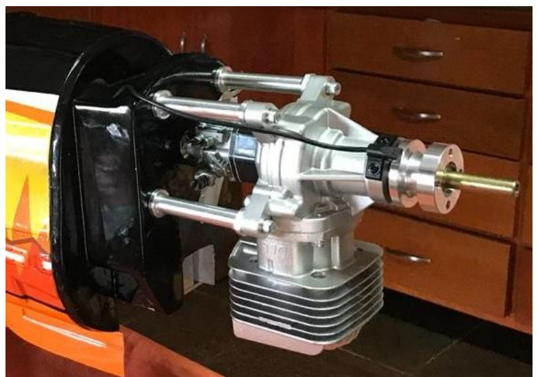
Acima: instalação dos montantes do motor (stand offs) e furos para pushrods do acelerador e afogador e mangueira tygon de gasolina (esquerda) e motor instalado nos montantes (direita).
