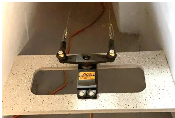
Acima: Horns duplos do leme (esquerda) e posição do servo de leme dentro da fuselagem (direita).
