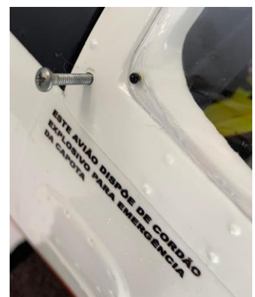
Acima: Parafusos para garantir segurança total na fixação do canopy e moldura do canopy.
