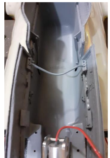
Acima: Instalação de mecanismo para abertura e fechamento das portas do trem de pouso dianteiro.
