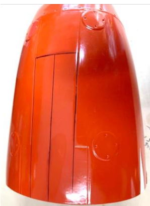
Acima: Fixadas com dobradiças Dubro, as duas portas dianteiras do trem de pouso dianteiro na carenagem inferior do motor (esquerda) e as duas portas traseiras do trem de pouso dianteiro na fuselagem (direita).
