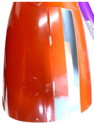
Acima: Fixadas com dobradiças Dubro, as duas portas dianteiras do trem de pouso dianteiro na carenagem inferior do motor (esquerda) e as duas portas traseiras do trem de pouso dianteiro na fuselagem (direita).
