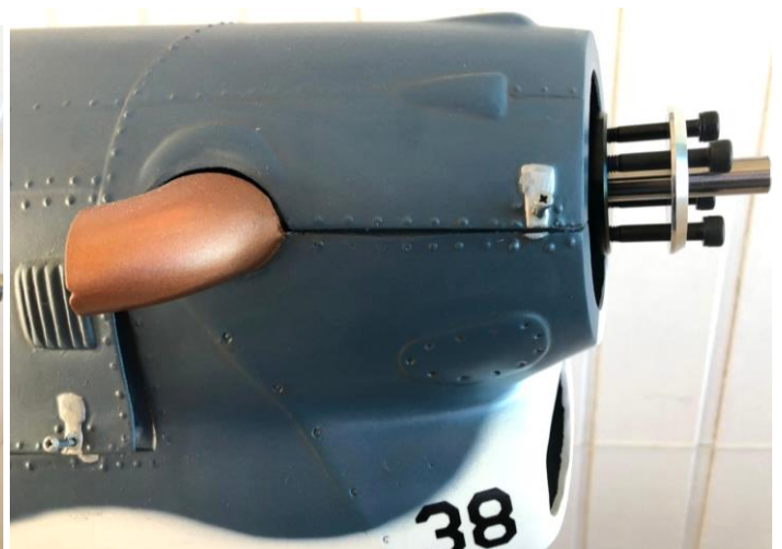
Acima: Instalação da parte inferior (esquerda) da carenagem do motor e ambas com alinhamento (direita).
