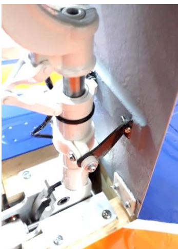
Acima: Detalhe da fixação dos suportes articulados à porta externa do trem de pouso principal (esquerda) e porta interna do trem de pouso principal com abertura e fechamento por cilindro pneumático (direita).
