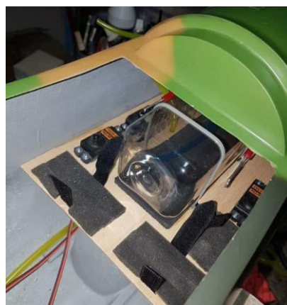
Acima: Posição típica do tanque e servos do acelerador e afogador. Abastecedores Johnny Simões (direita).
